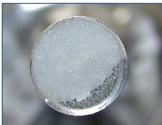
Сильное прилипание смеси к поверхности наконечника штампа.
